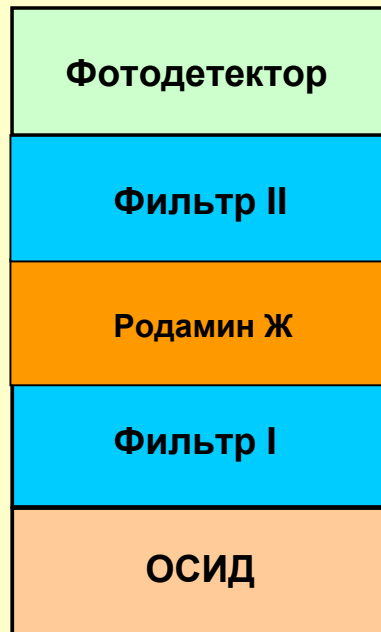
Схема макета пятислойного интегрального оптического хемосенсора
