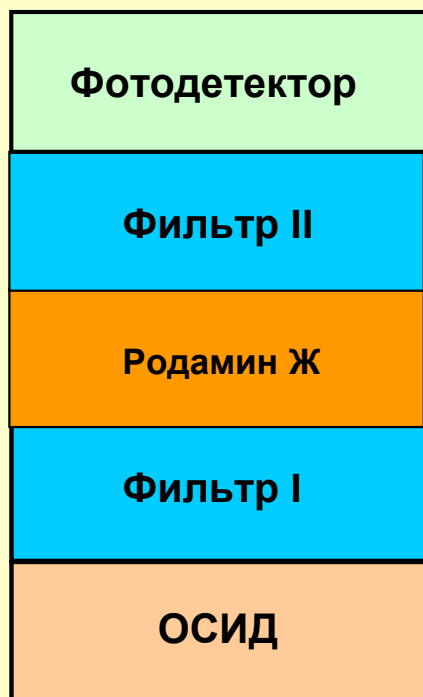
Схема макета пятислойного интегрального оптического хемосенсора
