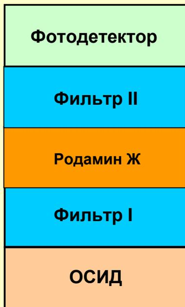
Схема макета пятислойного интегрального оптического хемосенсора
