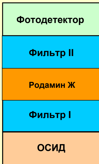
Схема макета пятислойного интегрального оптического хемосенсора
