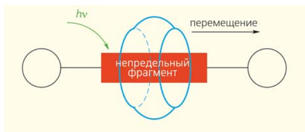
Рис.5. Схематическое представление фотоуправляемых супрамолекулярных машин на основе неопределенных соединений и кукурбитурилов.
