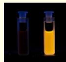
Разгорание флуоресценции красителя при комплексообразовании с Ba<sup>2+</sup>
