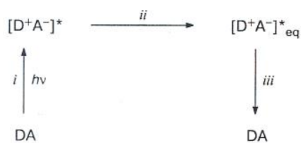
Рис. 8. Динамика возбужденного состояния супрамолекулярного КПЗ 2·12 . i . Прямая фотоиндуцированная реакция переноса электрона, \lambda = 616 нм, \Delta\tau_{1/2} \approx 70 фс. ii . Внутренняя колебательная релаксация, \tau_1 = 150 \pm 50 фс. iii . Обратная реакция переноса электрона, \tau_2 = 540 фс.
